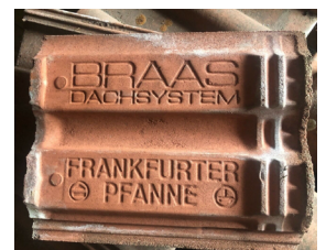
Beispielfoto: Ziegel (Rückseite mit Typbeschriftung)
